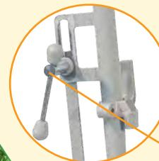
**El cable de mando tiene un sistema de regulación para parar la máquina inteligente e innovador que dispensa el cambio de pedales.**
